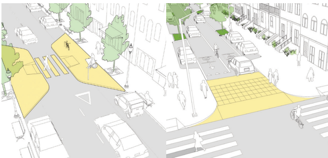
Fig. 18 Exemplos de soluções a implementar em Zonas 30 para o aumento da segurança nos atravessamentos Fonte: Street Design Guide
